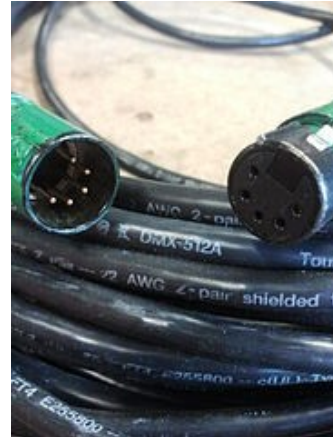
DMX-Kabel mit 5-Pin XLR Stecker/Buchse (DJSparky - Eigenes Werk; CC BY-SA 3.0 )
